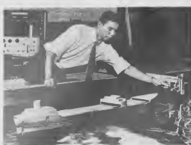
A TECHNICIAN at the Davidson Laboratory of the Stevens Institute of Technology tests a sixty-inch-long wooden model of a 73,000 deadweight-ton tanker in a special "wave-maker" tank. UN TECNICO na Davidson Laboratory di Stevens Institute of Technology ta ha cu un prueba cu un modelo di palo sesenta dm largo di un tanker di 73,000 ton peso morto den un tanki di awa.
